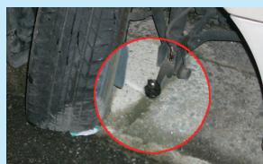
破損した前輪と車体をつなぐ装置
